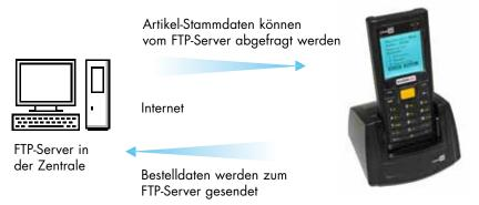
Low-cost Barcode-Terminal CipherLab 8200. Der Übertragungsadapter wird direkt ans Internet angeschlossen. Er dient auch als Akkuladegerät. Die FTP-Serverdaten: IP-Adresse, Username und das Passwort können ganz einfach mittels Barcodeliste im CipherLab 8200 gespeichert werden.
